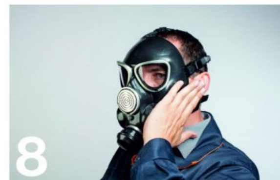
8 Проверить герметичность простейшим способом: закрыть ладонью седловину клапана вдоха и сделать глубокий вдох. При этом не должен попадать внешний атмосферный воздух в подмасочное пространство.
